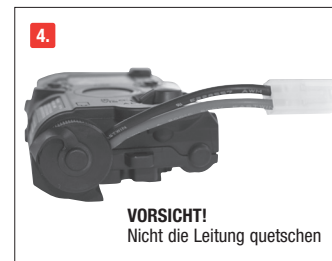
Nehmen Sie die Verschlussdeckel ab. Leitung & Akku wie abgebildet einführen.
