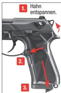
Magazinhalter drücken. Magazin entnehmen.
