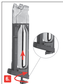
Kapselansteckschraube hochdrehen, CO 2 -Kapsel anstecken.
