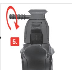
5. Der Spannhebel ist beidseitig montierbar.
