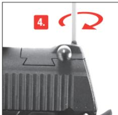
4. Fixez l'unité auxiliaire d'armement à l'aide d'une clé mâle à six pans de 1,5 mm.
