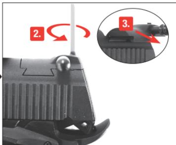
2. Avec une clé mâle à six pans de 1,5 mm dévissez l'unité auxiliaire d'armement 3. Tirez la culasse vers l'arrière, et retirez-la du guidage.
