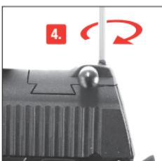
4. Fije la unidad auxiliar de amartillado con una llave Allen de 1,5 mm.
