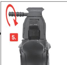
5. Le levier d'armement peut être monté des deux côtés.
