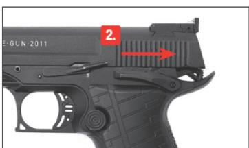
2. Para cargar el arma, tire de la palanca de armado hacia atrás hasta el tope y, a continuación, desplácela hacia adelante.
