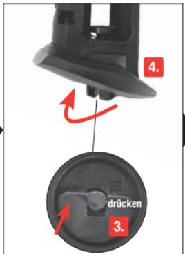
3. Drücken Sie auf die Schraube, damit der Schraubverschluss umklappt. 4. Kapselansteck-schraube nach unten drehen.
