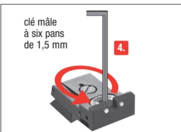
4. Dévissez légèrement la vis sans tête pour placer le cran de mire dans le guidage en queue d'hirondelle.
