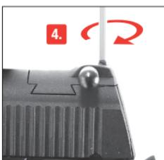
4. Mit einem 1,5 mm Inbusschlüssel die Spannhilfe-einheit fixieren.
