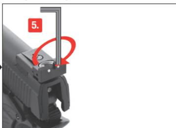
5. Apriete bien el tornillo. Presione hacia abajo la palanca de bloqueo de la corredera (desarmar la corredera).
