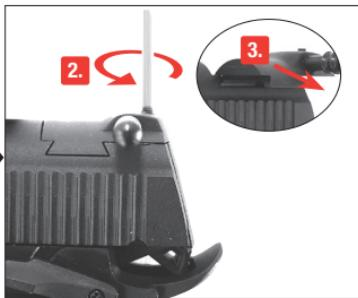
2. Mit einem 1,5 mm Inbusschlüssel die Spannhilfeeinheit lösen. **3.** Schlitten nach hinten ziehen und die Spannhilfeeinheit aus der Führung entnehmen.
