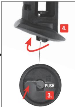
3. Ejerza presión sobre el tornillo para que gire el tapón rosado. 4. Girar hacia abajo el tornillo de pinchado del cartucho.
