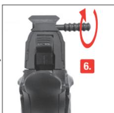
6. Presione hacia abajo la palanca de bloqueo de la corredera (desarmar la corredera).
