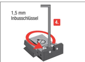
4. Schrauben Sie die Madenschraube mit einem 1,5 mm Inbusschlüssel etwas heraus, um die Kimme in die Schwabenschwanzführung zu setzen.
