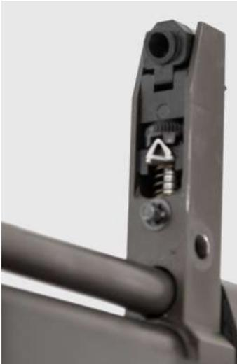
La ligne de visée est réglée pour l'élévation en déplaçant l'unité de visée comme suit. Abaissez la molette de réglage, puis comprimez le ressort à grain annulaire à l'aide de la vis. Pour faciliter cette opération, on peut utiliser un couteau ou un tournevis pour comprimer le ressort.
