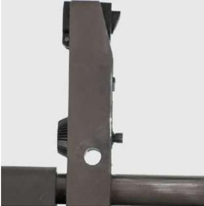
— En lumière normale, maintenez les deux volets du chariot de hausse fermés, le diamètre de l'œilleton est minimum et donne le maximum de précision.
